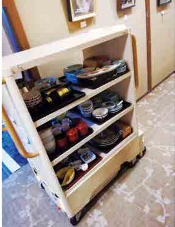
すだれが掛かり、鶴の文様が描かれている配膳ロボット。タブレットで配膳ロボットを設定し、たくさんの食器を自動で運び、省人化を図っている
